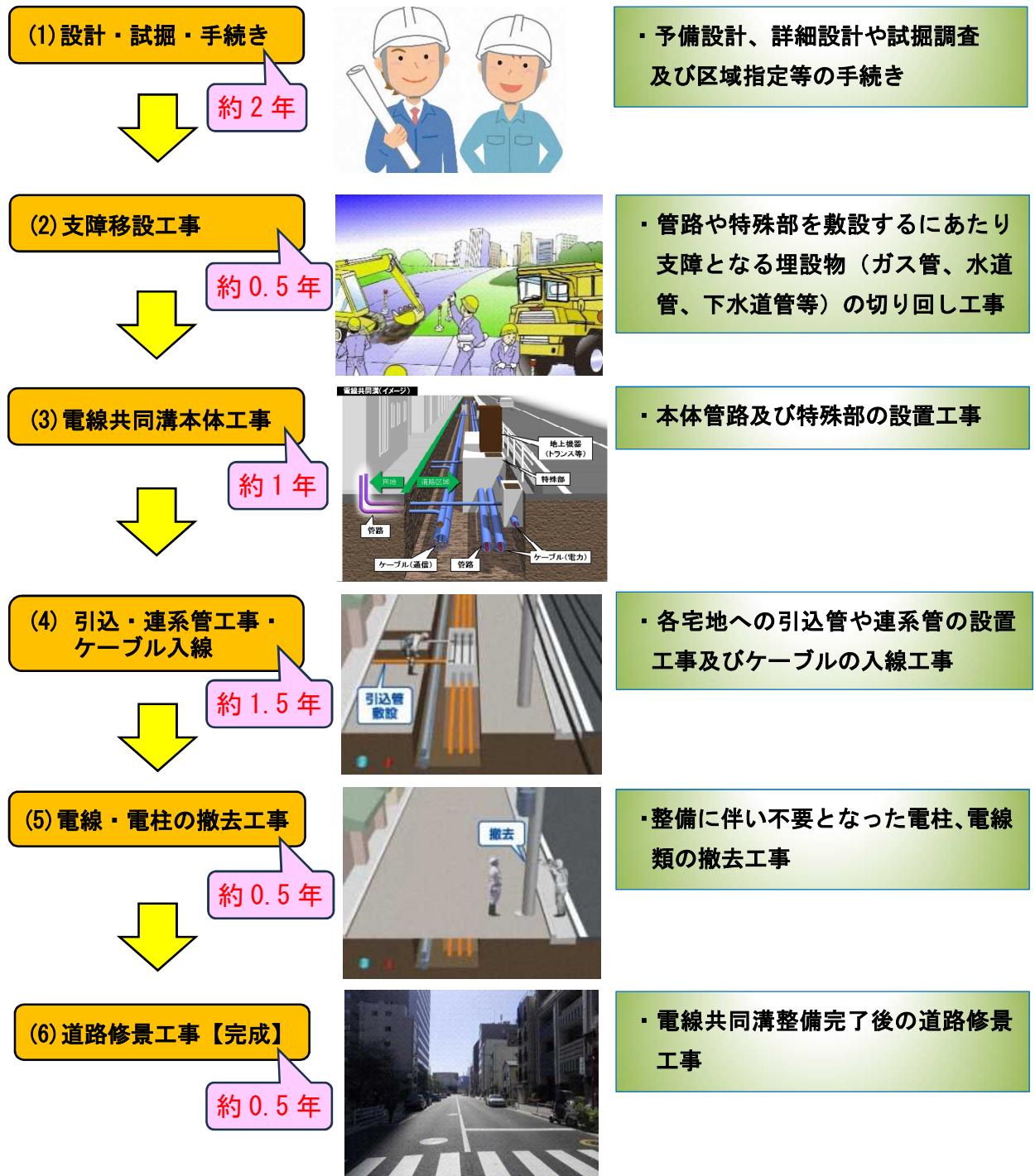
図 3-2 電線共同溝整備の標準的な工程
