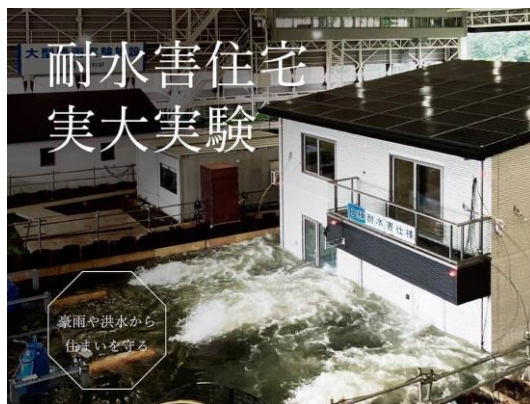
耐水害住宅の実大実験 (一条工務店)
